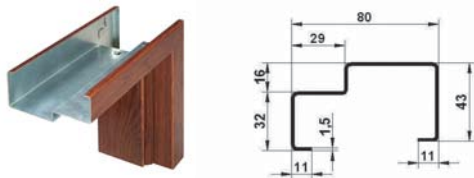
ASSYMETRISCHE ZARGE OHNE DICHTUNG FB (für Türen TT und GTT)
