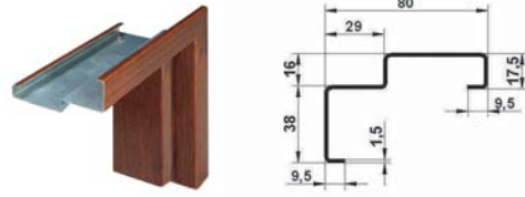
ECKZARGE OHNE DICHTUNG FN (für Türen TT und GTT)
